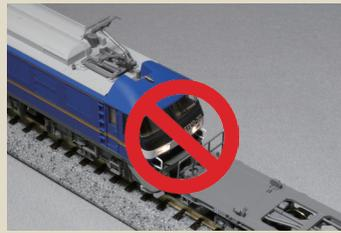
リップフィルタを搭載し、進行方向逆方向のライトちらつきを防止します。
